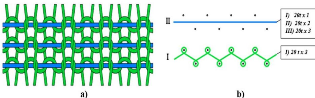
**Rasm 1.** Arqoqli lastik trikotaj to'qimasining I-II-III variantini tuzilishi (a) va grafik yozuvi (b)
