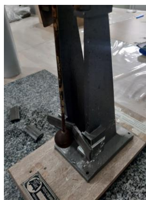
4- рисунок. 7 Определение ударной вязкости. Сущность метода заключается в разрушении образца падающим маятником.
