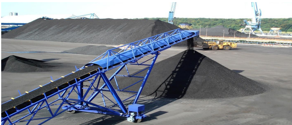
1-rasm konveyer lentasi yordamida tashish jarayoni.
