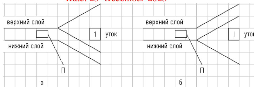
Рис. 2. Прокидка утка при образовании мешковой ткани.
